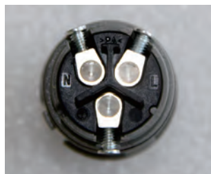
▲ Figure 4.13 Connettore terminale di rete AC all'interno
