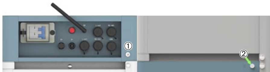
Fig. 3.6 - Il cavo di messa a terra dei moduli Force-H1 sul punto di messa a terra (sopra il lato destro della vite della staffa metallica superiore (1) o accanto a entrambi i lati della vite (2).
