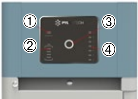
Fig. 2.4 - Display del modulo di controllo FC0500M-40S-V2 1) indicatore stato sistema, 2) indicatore livello di carica batteria (una tacca indica il 25% di carica), 3) pulsante led, 4) indicatore di stato del modulo batteria
