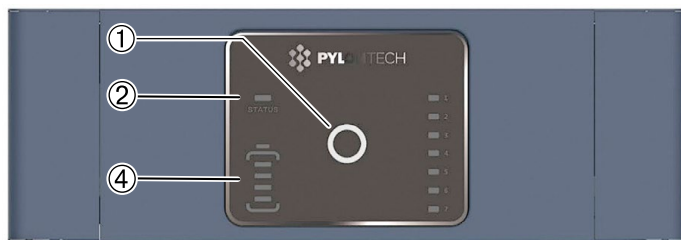
Fig. 4.2 - Modulo di controllo FC1000, vista frontale
