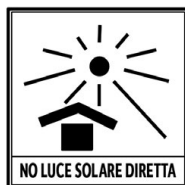
Fig. 3.1 - Non esporre alla luce solare diretta, campo di temperatura -10° ~ 55°C, installare su un terreno piano e uniforme.
