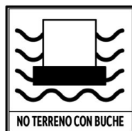
Fig. 3.1 - Non esporre alla luce solare diretta, campo di temperatura -10° ~ 55°C, installare su un terreno piano e uniforme.
