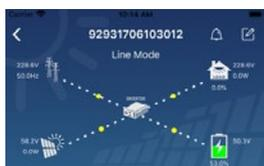
L'inverter alimenterà il carico dall'utilità con o senza ricarica fotovoltaica. La rete elettrica o la fonte fotovoltaica possono caricare la batteria.
