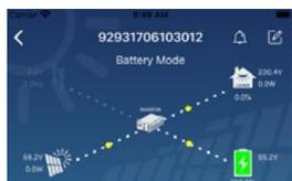
L'inverter alimenterà il carico dalla pastella con o senza ricarica fotovoltaica. Solo la fonte fotovoltaica può caricare la batteria.
